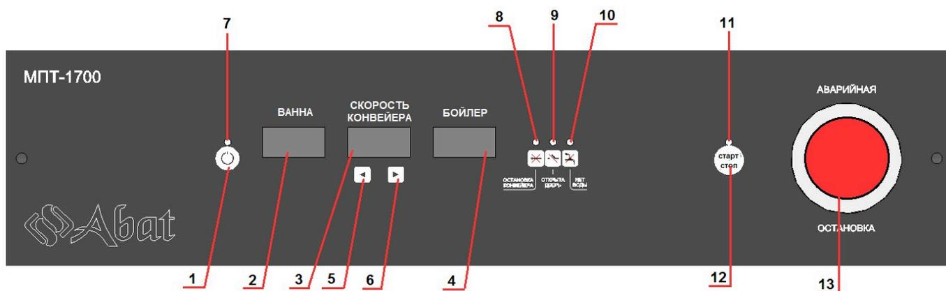
Рис. 2.1 Панель управления машин МПТ-1700, 1700л, 1700-01, 1700-01л
